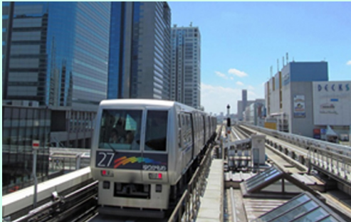
รถไฟฟ้าสาย Yurikamome ของญี่ปุ่น ไม่ใช้พนักงานขับรถ (ที่มา: http:// wikimapia. org/685476/ Odaiba-Kaihin- Koen-Station )
