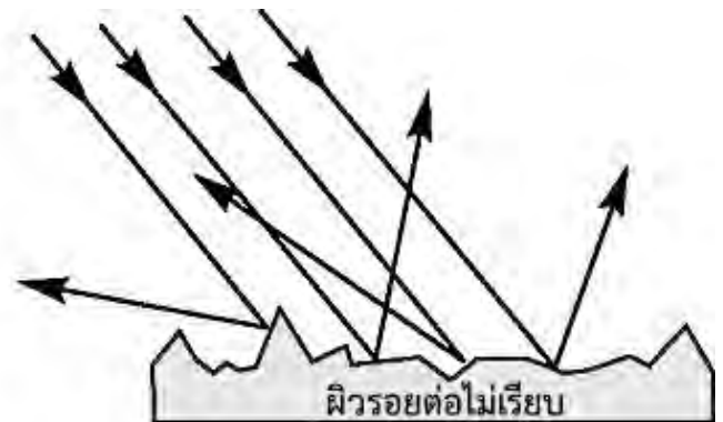
รูปที่ 3 ภาพเปรียบเทียบแนวแสงสะท้อนในกรณีที่ ผิวรอยต่อเรียบ (บน) และ ผิวรอยต่อไม่เรียบ (ล่าง)
