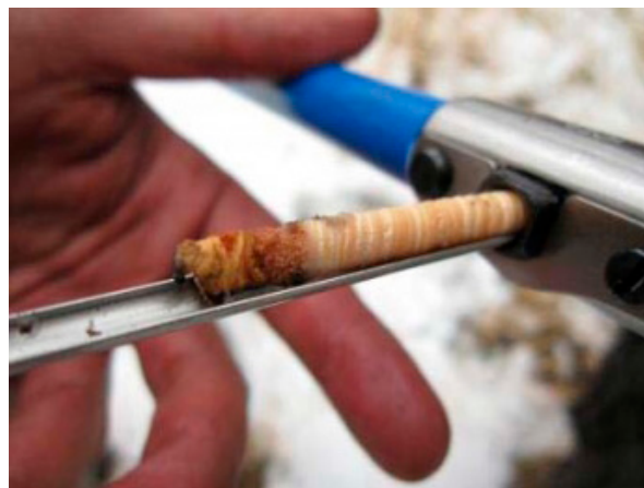
ภาพที่ 4 การใช้ลิ่มนำตัวอย่างไม้ออกจากดอกสว่าน
