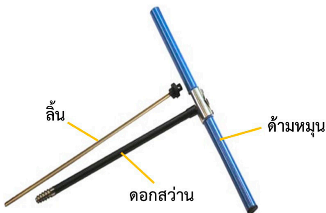
ภาพที่ 3 Increment Borer หรือ สว่านหมุนมือ
