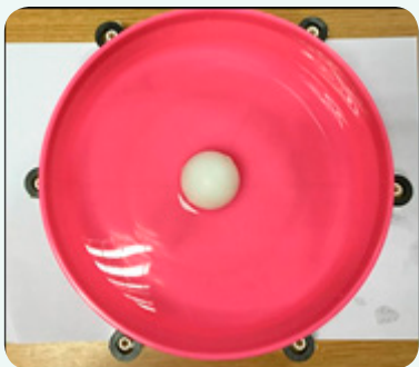
รูปที่ 3 เวิร์ดปิงปองลอยอยู่ตรงกลางภาชนะจากสมดุลของแรงแม่เหล็ก
