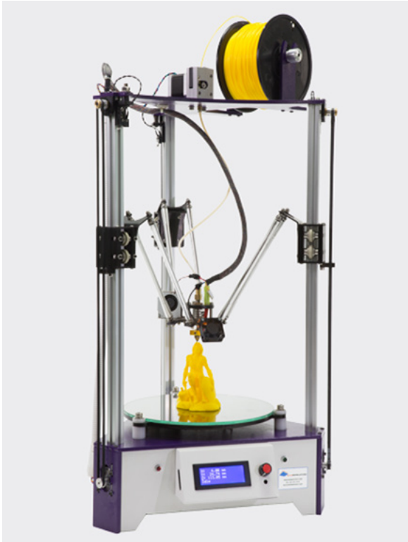
ภาพที่ 3 เครื่องพิมพ์ระบบ delta ที่มา http://www.applicadthai.com
