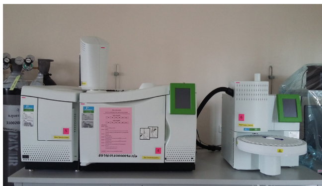
ภาพ เครื่องแก๊สโครมาโทกราฟี-แมสสเปกโตรมิเตอร์
