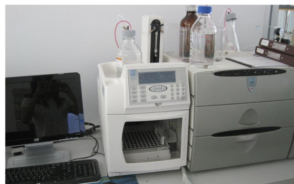
ภาพ เครื่องโครมาโตกราฟีของเหลวสมรรถนะสูง
