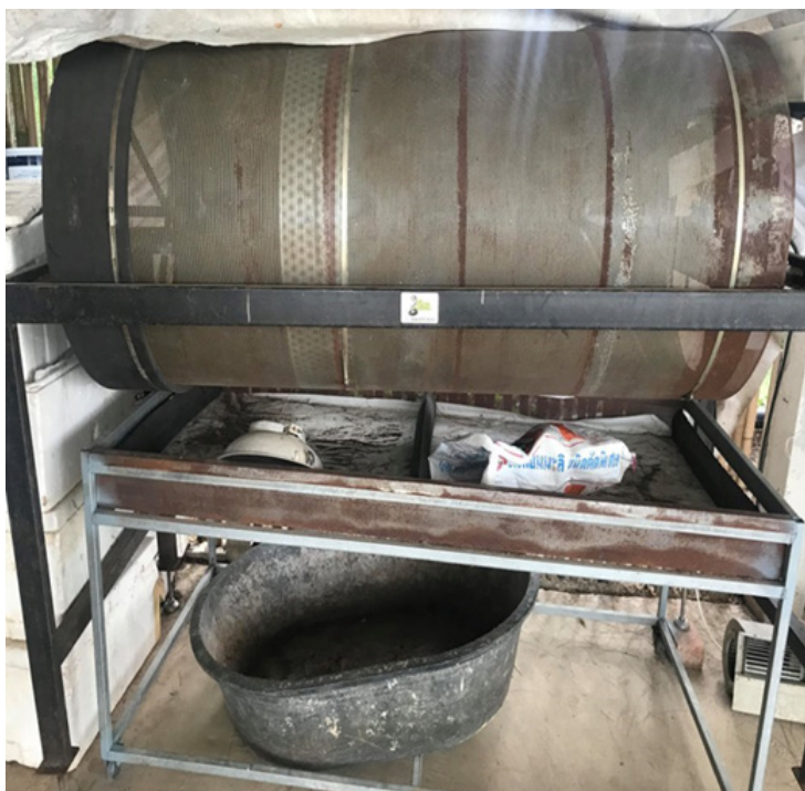
ภาพ 3 เครื่องร่อนมูลไส้เดือน
