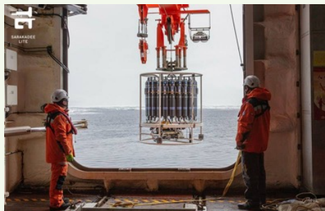
(ข) วิธีการเก็บตัวอย่างน้ำทะเลโดยหย่อนเครื่องมือจากด้านข้างของเรือ ลงไปในน้ำทะเลที่ระดับความลึกที่ต้องการ ที่มา: Sarakadee Lite (2568)
