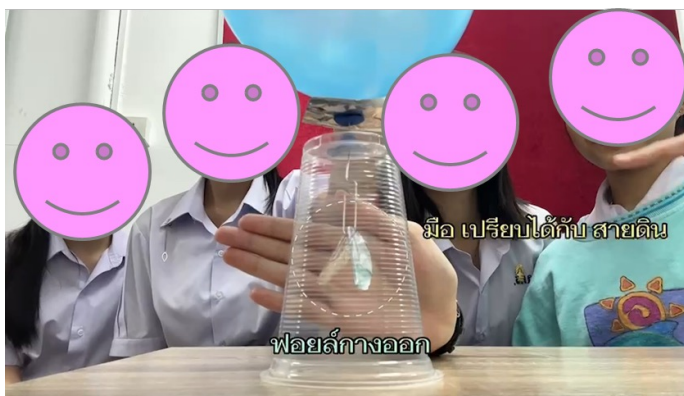
ภาพ 1 การทดลองโดยใช้อิเล็กทรอนิกส์แบบแผ่นโลหะที่ผู้เรียนช่วยกันประดิษฐ์ขึ้น เพื่อใช้ตรวจสอบประจุไฟฟ้าและเหนี่ยวนำอิเล็กทรอนิกส์ให้มีประจุไฟฟ้า
