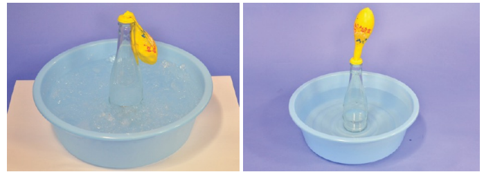
ภาพ 2 ลูกโป่งที่ครอบอยู่บนปากขวดแก้วที่แช่ไว้ในน้ำแข็ง (ซ้าย) เปรียบเทียบกับขนาดของลูกโป่งที่ครอบอยู่บนปากขวดแก้วที่แช่ไว้ในน้ำร้อน (ขวา)
